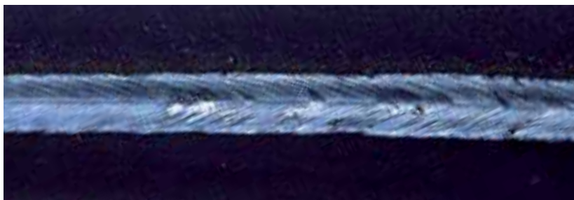
Přeplátovaný svar v režimu SSA™; 2mm tloušťka; 1,2m/min.
